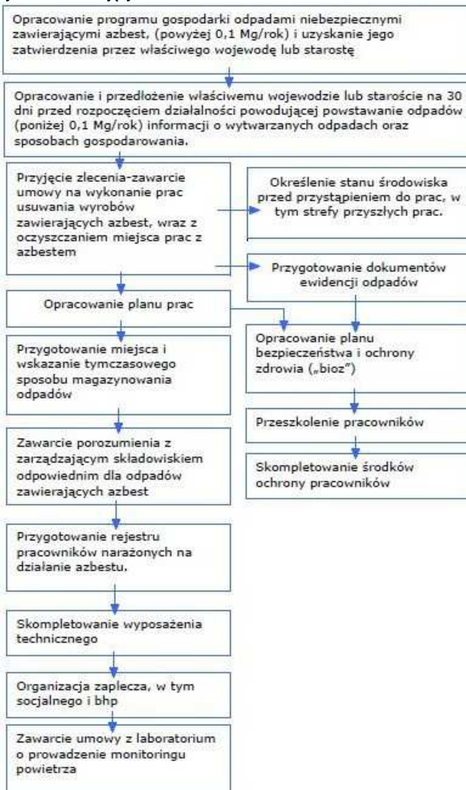
Rysunek 4. Schemat procedury dotyczącej postępowania przy pracach przygotowawczych do usuwania wyrobów zawierających azbest.
