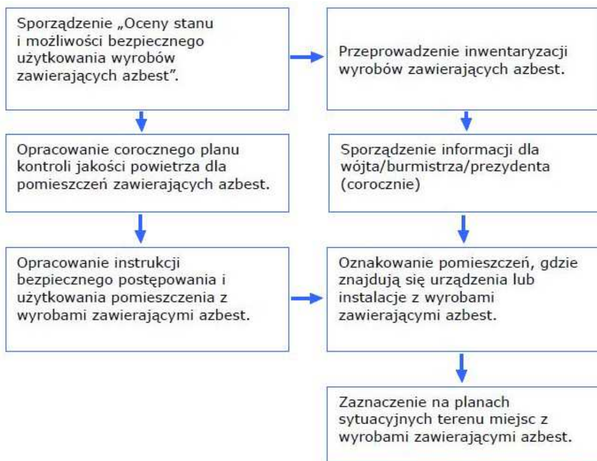
Rysunek 2. Schemat procedury postępowania właścicieli i zarządców przy użytkowaniu obiektów i terenów z wyrobami zawierającymi azbest.
